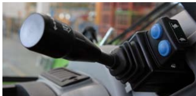
▶▼ Il comando elettrico Finger-Touch permette di invertire la direzione di marcia senza distogliere le mani dal volante. Il selettore di marcia lenta o veloce è elettrico con comando a pulsanti su Roto MCSS, (foto a destra) o con interruttore basculante su Roto serie 600 e 400 (foto in basso).
