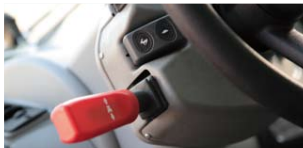
▶▼ Il comando elettrico Finger-Touch permette di invertire la direzione di marcia senza distogliere le mani dal volante. Il selettore di marcia lenta o veloce è elettrico con comando a pulsanti su Roto MCSS, (foto a destra) o con interruttore basculante su Roto serie 600 e 400 (foto in basso).
